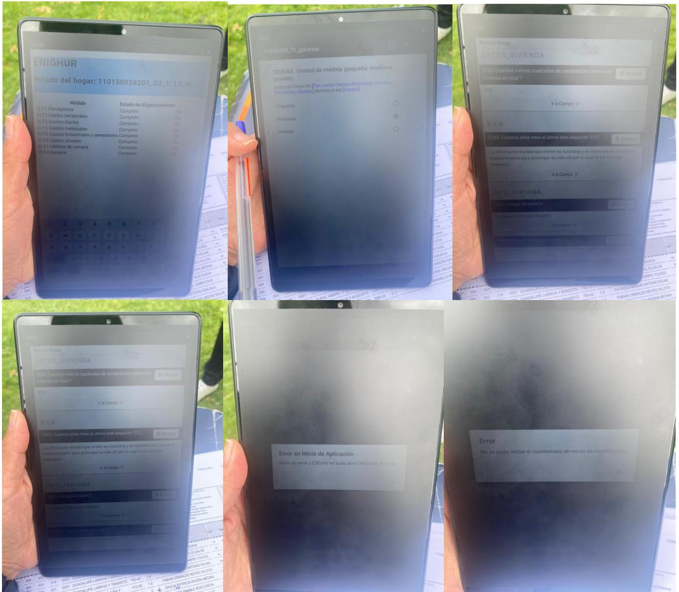
Además, se recomendó cambiar la mica ya que este tipo estaba como polarizado y se tenía que poner el brillo al 90% para poder visualizar el contenido de la pantalla de la Tablet, esto afecta la batería en cuanto a su duración y acorta su vida útil.
