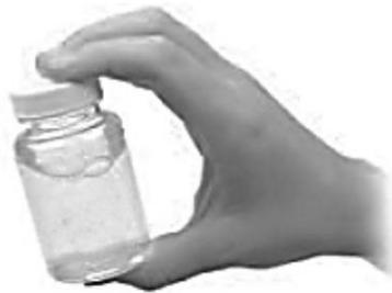
Paso 5. Bata el contenido del frasco por 30 segundos o hasta que se disuelva por completo el reactivo.
