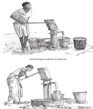
**Pozo protegido:** es un pozo de agua cavado que se encuentra protegido de las aguas escurridas mediante un revestimiento o tubería elevada por encima del nivel del suelo y una plataforma que desvía el agua derramada para que no fluya dentro del pozo. Los pozos cavados protegidos se encuentran cubiertos, además, para impedir que los excrementos de aves y los animales caigan dentro del hoyo.
