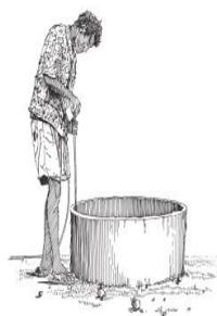
**Manantial/vertiente Protegida (No conectado a tubería):** está a resguardo de aguas que se desbordan y de los excrementos de aves y animales. El manantial, generalmente, se encuentra protegido por una “caja de manantial” hecha de ladrillo, mampostería o concreto, construida alrededor del manantial de manera que el agua fluya directamente desde la caja hacia una tubería, sin exponerse así a la contaminación externa
